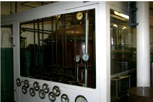
In unserem Feinbrandgerät wird der Rohalkohol zu sogenannten Feinbrand destilliert. Über 40 mal wird der Alkohol in Dampfform gebracht, und nur der Mittellauf ist für Kempers Produkte gut genug.
